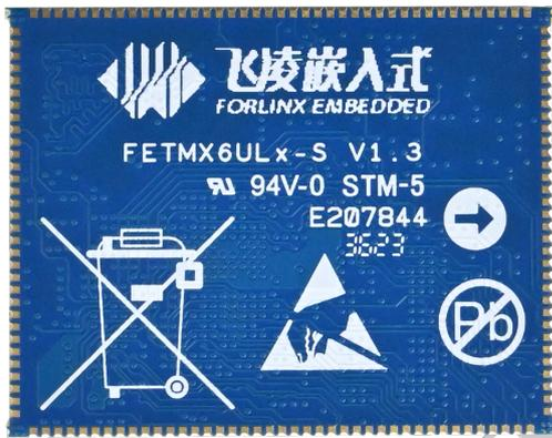
注: PCB 厚度 1.2mm; PCBA 总高度 2.6mm; 尺寸公差±0.2mm。
